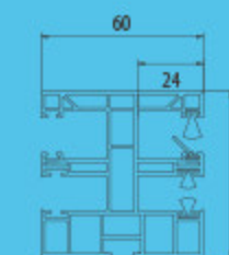
PVC PPDM 60/12 Führung für Rollläden Opoterm mit integriertem Moskitonetz. Verwendete Schrauben – RD2.
